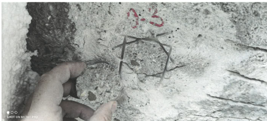
Obr. 12: Odtrhová zkouška O-3 na povrchu ŽB věnce – zkušební plocha Z1.
