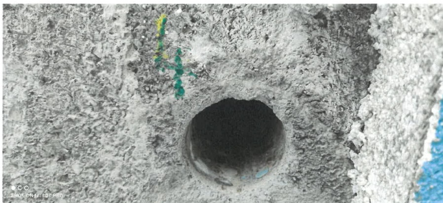
Obr. 16: Pohled na sondu po odběru jádrového vývrtu 4, která byla provedena v konstrukci ŽB věnce – zkušební plocha Z2.
