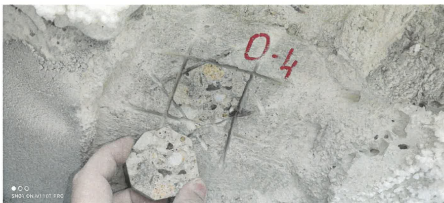
Obr. 18: Odrhová zkouška O-4 na povrchu ŽB věnce – zkušební plocha Z2.
