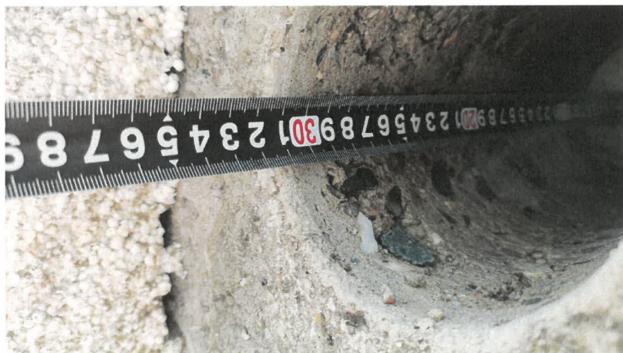
Obr. 8: Pohled do sondy po odběru jádrového vývrtní A1 – tloušťka dobetonávky je cca 290 mm (bez vrstvy omítky).
